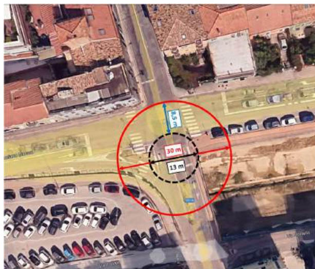
Fig. 100 – Geometria della rotatoria SS 16/Corso Cavour – Via Manara /Via Gino Moretti
