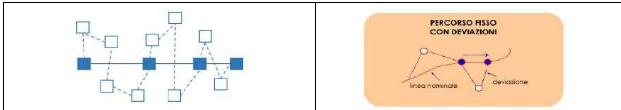
Fig. 126 – Schema di funzionamento dei servizi a chiamata su percorsi fissi con deviazioni
