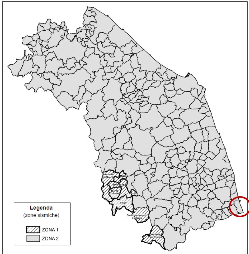
Fig. 4: classificazione in zone sismiche comuni Regione Marche (D.G.R. n.1142 del 19/09/2022)
